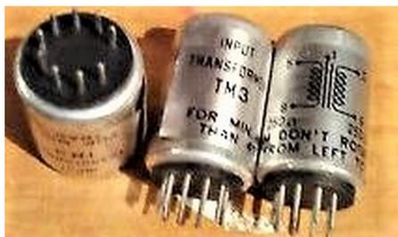
Trasformatore traslatore per microfono - da innesto
